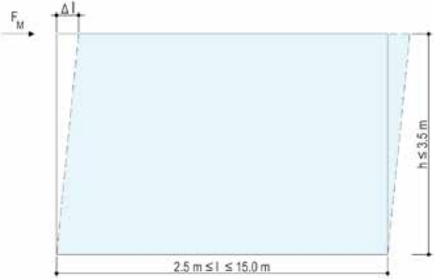
Şekil 2: Düz durumda yanal yük
