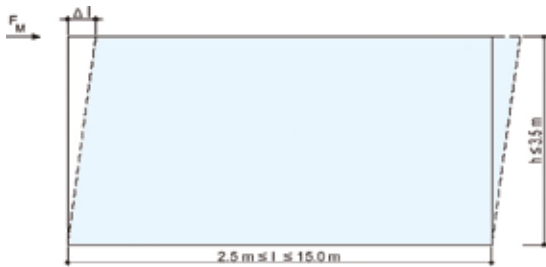
Şekil 2: Düz haldeki yanal yükler
