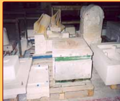
Resim 3. Alçı kalıp ve seramik çamuru dökülmüş kalıp-Eczacıbaşı [4]
