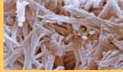
Resim 1. Alçı taşının kristal yapısı [3]
