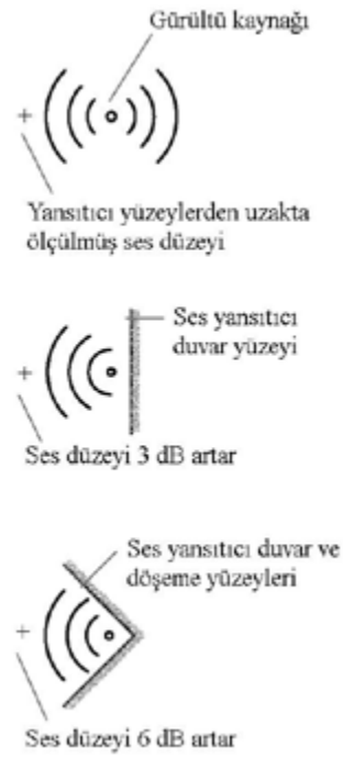
Şekil 3: Ses yansıtıcı yüzeylerin etkisi
